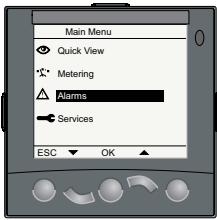
Дисплей индикатора FDM121: перемещение по меню
