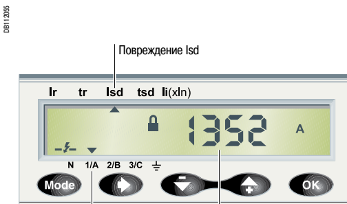
Индикация тока повреждения
